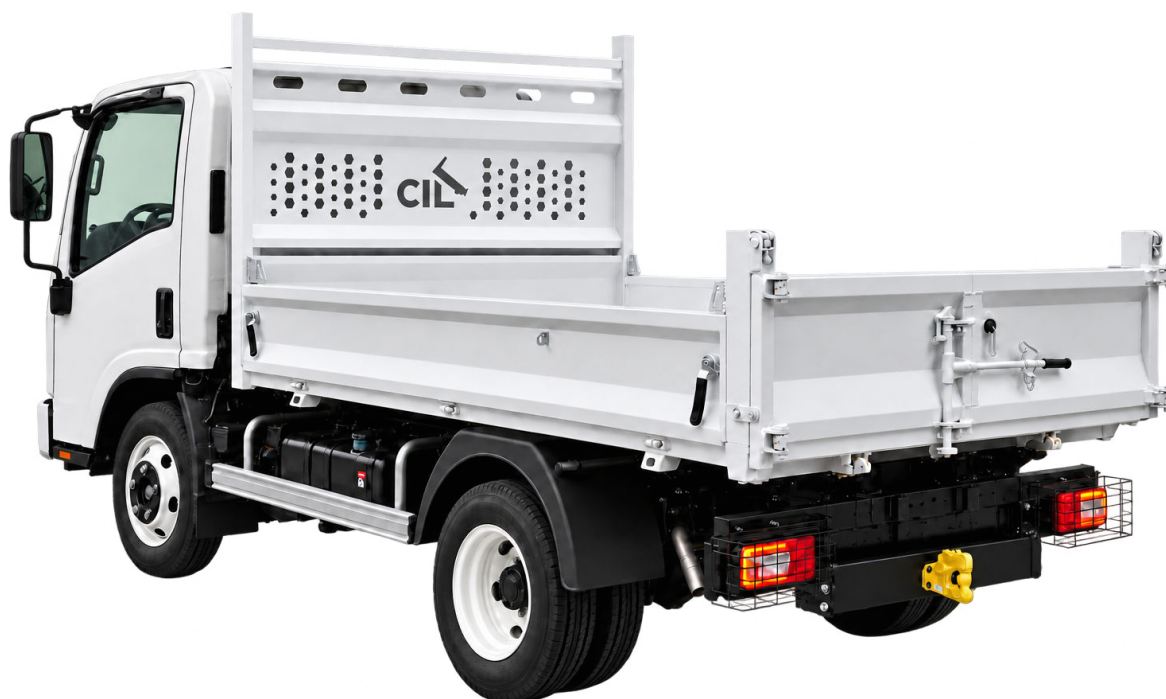
Benne CIL 3,5 t avec ridelles rabattables et porte arrière universelle à deux vantaux.
